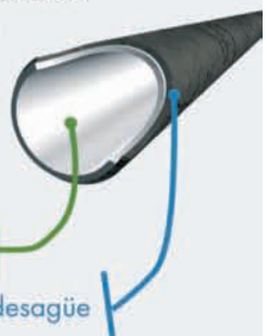
Nueva tubería dentro de la antigua Tubería de desagüe
